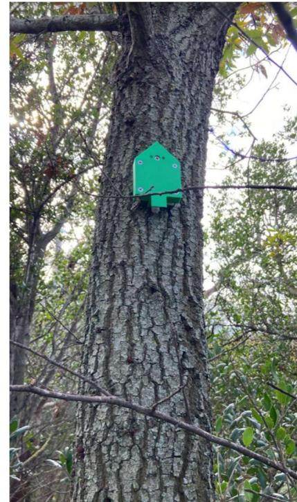
Nel momento in cui tale indice va fuori da un determinato range, viene attivata una comunicazione radio, con tecnologie LoRaWAN e inviato in tempo reale un segnale di allarme in cloud, altrimenti, se l'indice rimane all'interno del range, il dispositivo ritorna nello stato di Low Power.
