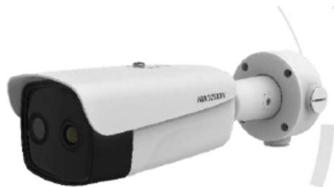
In particolare le telecamere installate sono della Hikvision codice DS-2TD2637T-15/QY che è una telecamera termica e ottica a doppio spettro Risoluzione 384 × 288 che oltre a fornire il servizio di videosorveglianza è capace di rilevare un incendio di dimensione di 0,2 m x 0,2 m ad una distanza di 150 m, e un incendio di 2 m x 2 m ad una distanza di 1500 m.
