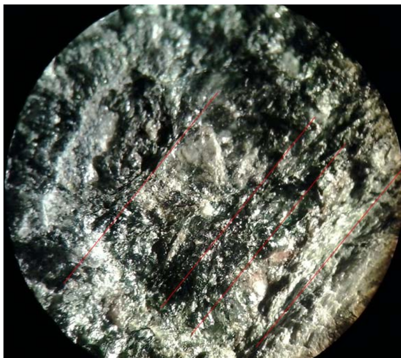
Figura 1 – Analisi allo stereomicroscopio: Aggregati cristallini lamellari di colore verde (serpentino) emergono da una mesostasi molto scura (carattere lherzolitico) e costituiscono la foliazione milonitica. Sulla superficie la patina di cristallizzazione biancastra appare a composizione carbonatica e costituisce il cemento della breccia
